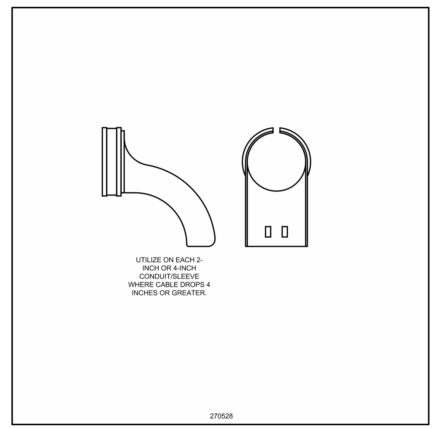
3 | 270528 CONDUIT RADIUS CONTROL NTS
